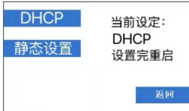
服务器出场默认为 DHCP 模式，如果 DHCP 无法联网请选择静态设置，点击静态设置后界面如下图所示
