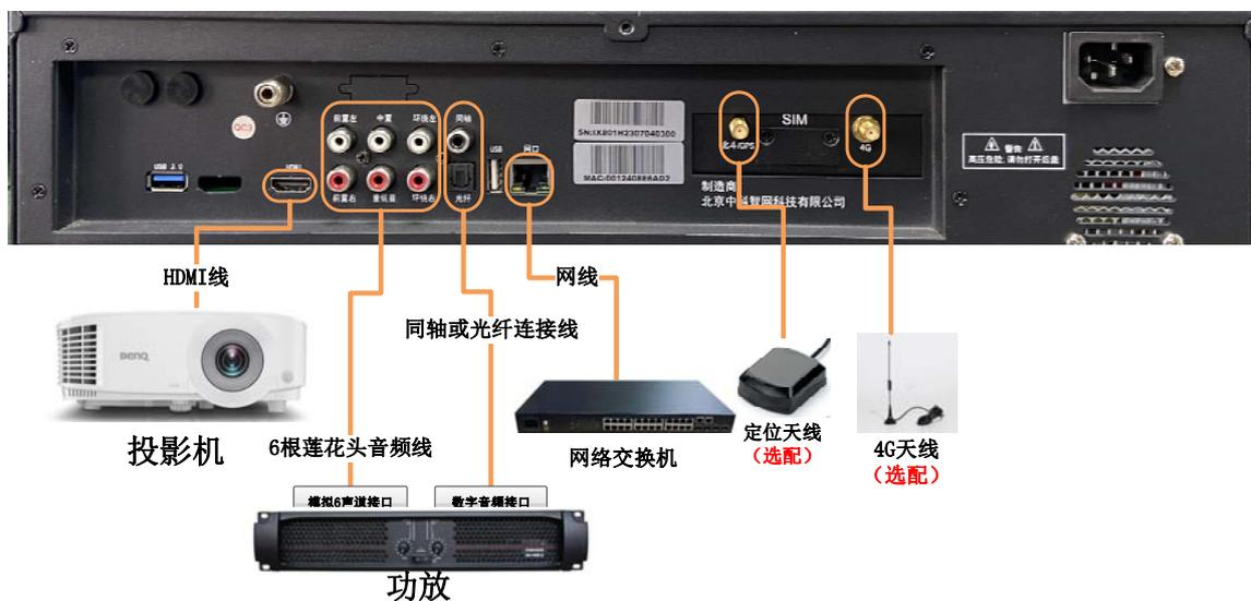
1. HDMI 接口：使用数字视频接口线连接投影设备
