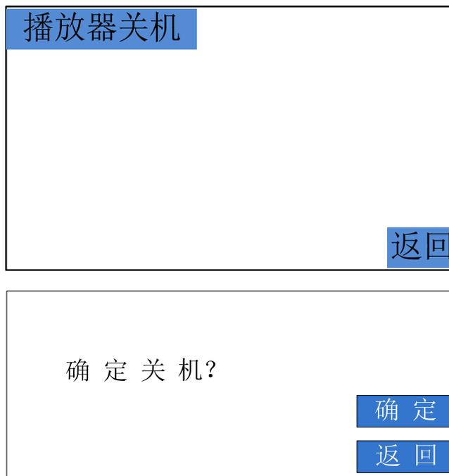
按“返回”键，取消关机操作，返回操作主界面；按“确定”键，数字电影播放器进入关机状态，液晶屏将显示“关机结束请断电”字样，如下图所示：
